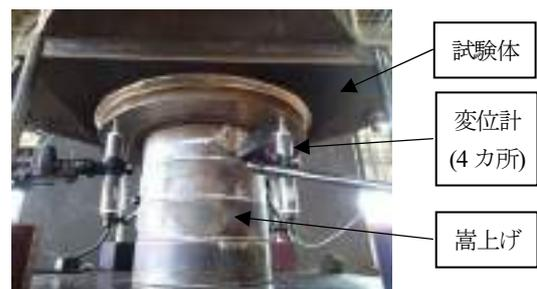
図-20 一軸載荷試験(試験体部)
